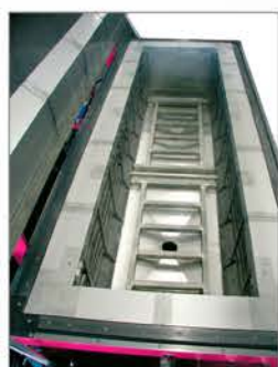
Камера очистки от VACUCLEAN 254
