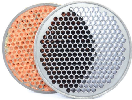
Foto: Thermische Reinigung von Lochplatten – vorher/nachher
