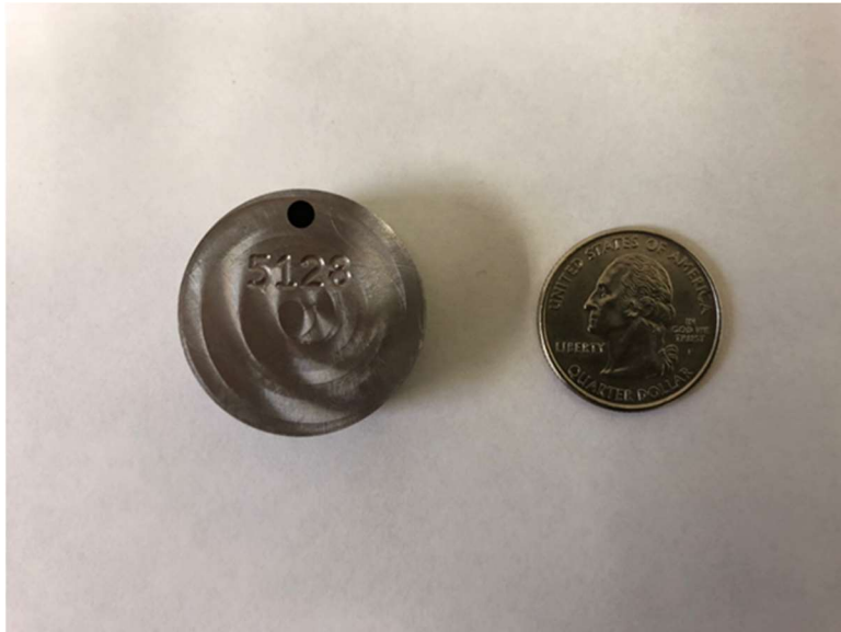
Abbildung 3: Typische Probe, die für die Bainitisierung verwendet wurde - hier im Vergleich zu einer US-Viertel-Dollar-Münze
