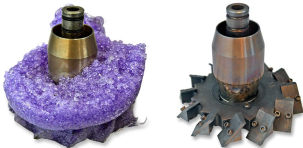
Die thermische Reinigung von Maschinenteilen, wie z.B. Granuliermessern, reduziert Kosten, erhöht die Maschinenverfügbarkeit und steigert die Produktivität Bildnachweis: SCHWING Technologies
