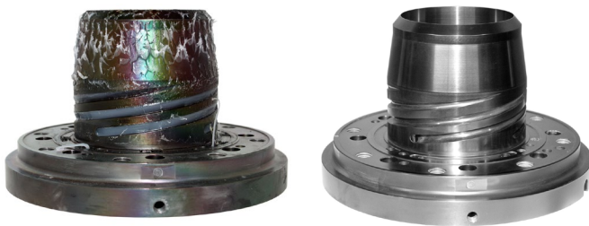
Die Reinigung von Folienblasköpfen geschieht vollautomatisch in einer elektrisch beheizten Vakuum-Reinigungskammer Bildnachweis: SCHWING Technologies
