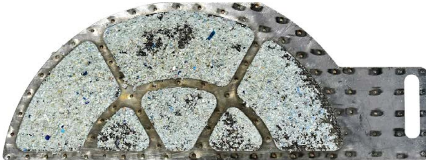
Mit rPET-verschmutzter Metallfilter vor der Reinigung
